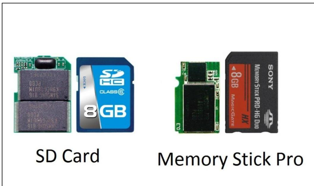
Figura 49 – Interior memoria “SD Card” y “Memory Stick Pro” luego de quitar el encapsulado – Fuente: Producción Propia
