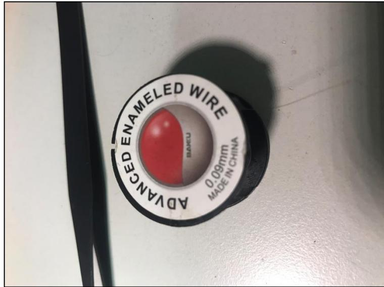
Figura 26 – Alambre barnizado – diámetro 0.09 mm – Fuente: Producción Propia
