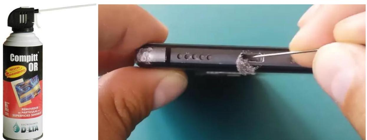
Figura 36 – Aire inerte comprimido “Compitt OR” marca DELTA - Limpieza puerto USB con alfiler – Fuente: Producción Propia
