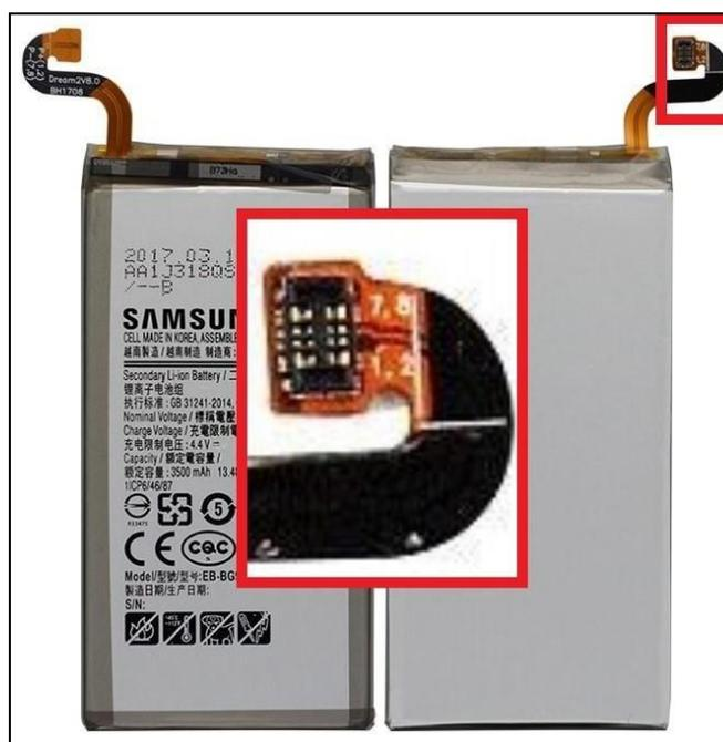
Figura 47 – Conector batería interna celular – Fuente: Producción Propia
