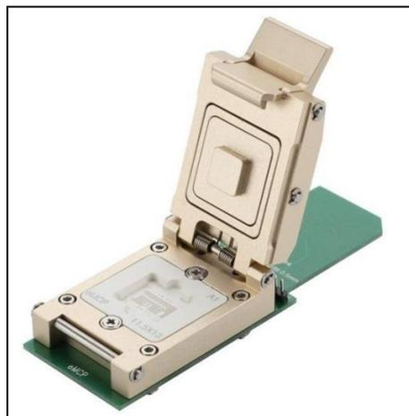
Figura 33 - Adaptador SIREDA BGA a SD – Fuente: Producción Propia
