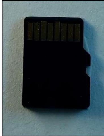
Figura 55 – Memoria micro SD fijada a la mesa con cinta doble faz – Fuente: <http://www.pc3000flash.com/>
