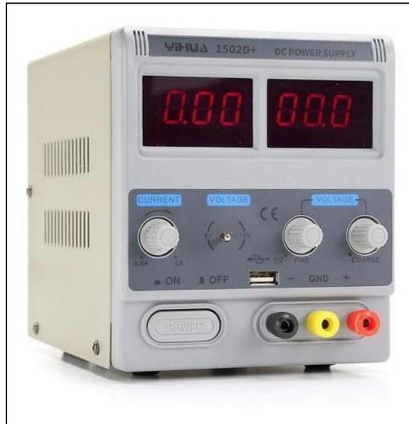
Figura 45 – Fuente de alimentación digital Yihua 1502D+ – Fuente: Producción Propia
