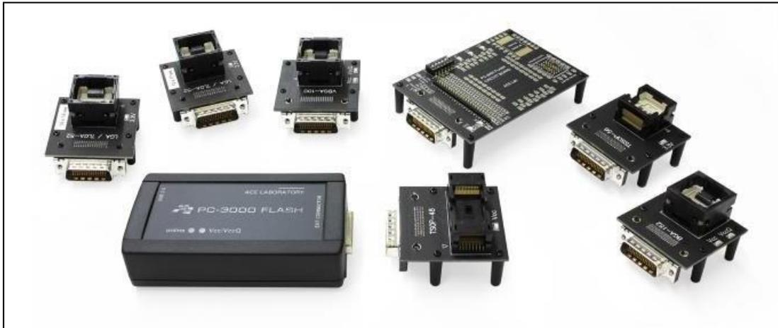
Figura 60 – PC-3000 y accesorios de la empresa ACELab – Fuente: <http://www.pc3000flash.com/>
