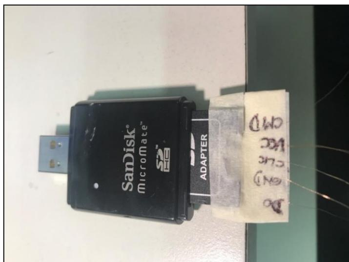
Figura 23 – Lector USB con adaptador para micro SD modificado para ISP – Fuente: Producción Propia
