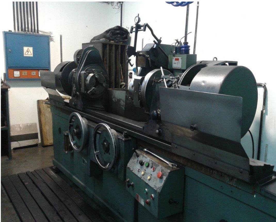
Esta máquina se utiliza para la rectificación de los apoyos de los cigüeñales en las bancadas del block, utiliza para la tarea piedra de amolar y líquido refrigerante, el líquido refrigerante está compuesto por agua y un polvo especial exclusivo para la tarea de desbaste, este líquido impide que la superficie tome temperatura durante el proceso y pueda llegar a modificar la estructura del material.
