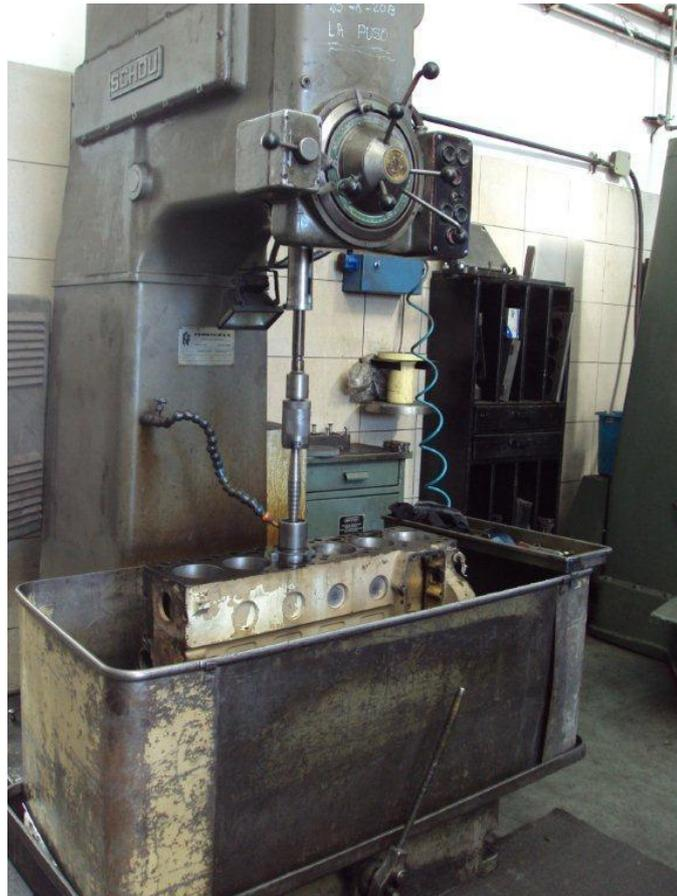
Esta máquina realiza el trabajo similar al de la rectificadora de cilindros, pero su función es eliminar los posibles defectos que hayan quedado de la tarea de desbaste anterior, utiliza el mismo tipo de herramienta que una rectificadora.
