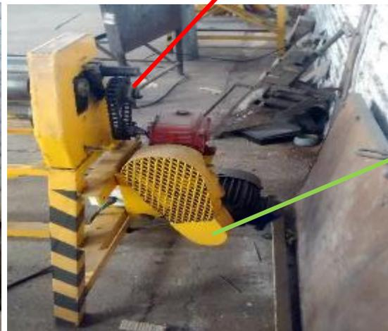
Falta protección en sistema de transmisión.
