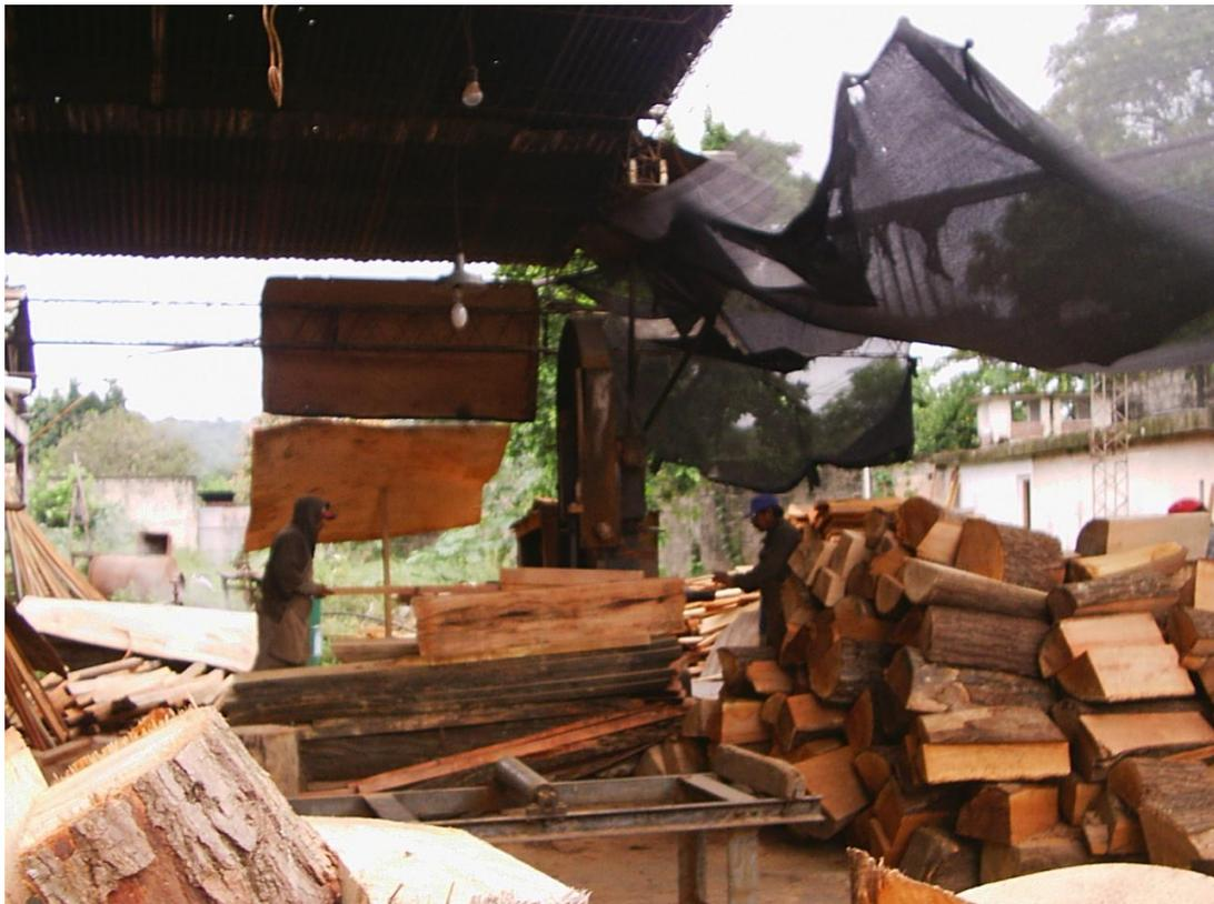
**Figura 10 (Deshechos generados en el proceso de serrado).**
