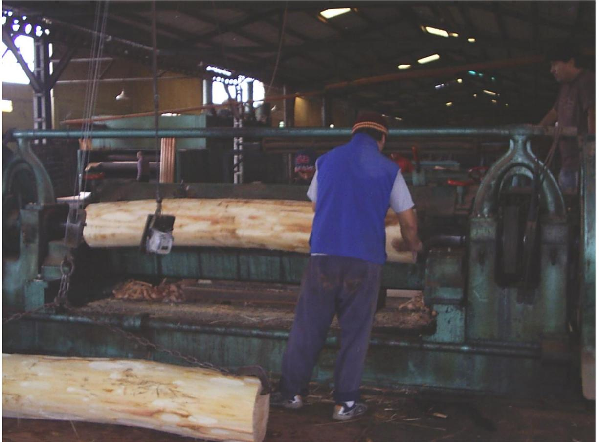
**Figura 4 (Operarios en descortezadora)**
