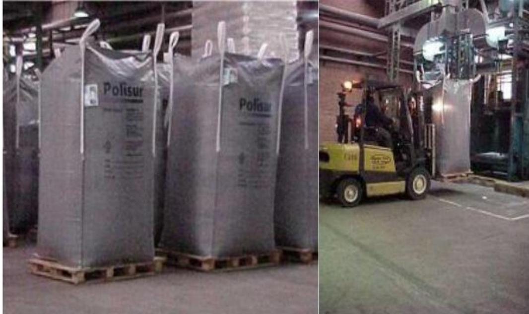
El modo de empaque a granel de polietileno se realiza mediante una máquina de diseño DOW que permite la carga de un contenedor, el cual en su interior está recubierto con el Liner. Esta máquina proyecta el polietileno que se descarga desde un silo, mediante una cinta transportadora, la cual puede variar de dirección y velocidad, cambiando el flujo del polietileno, acopiándolo dentro del contenedor en forma homogénea.
