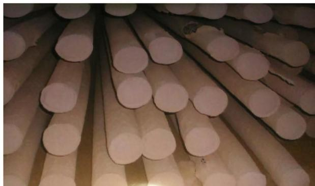
Mangas de filtros en sus canastos deterioradas.
