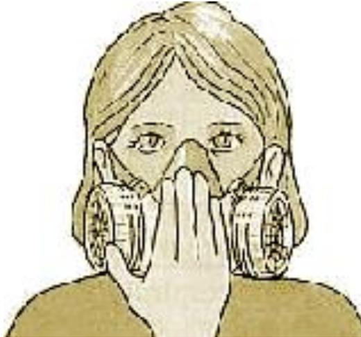
Prueba de presión negativa- Bloquee la rejilla o rejillas de inhalación con las palmas de las manos (como se indica en el dibujo) inhale lentamente durante 10 segundos. Si la mascarilla se colapsa ligeramente y no detecta fuga de aire entre su cara y la mascarilla, se ha obtenido un ajuste apropiado.
