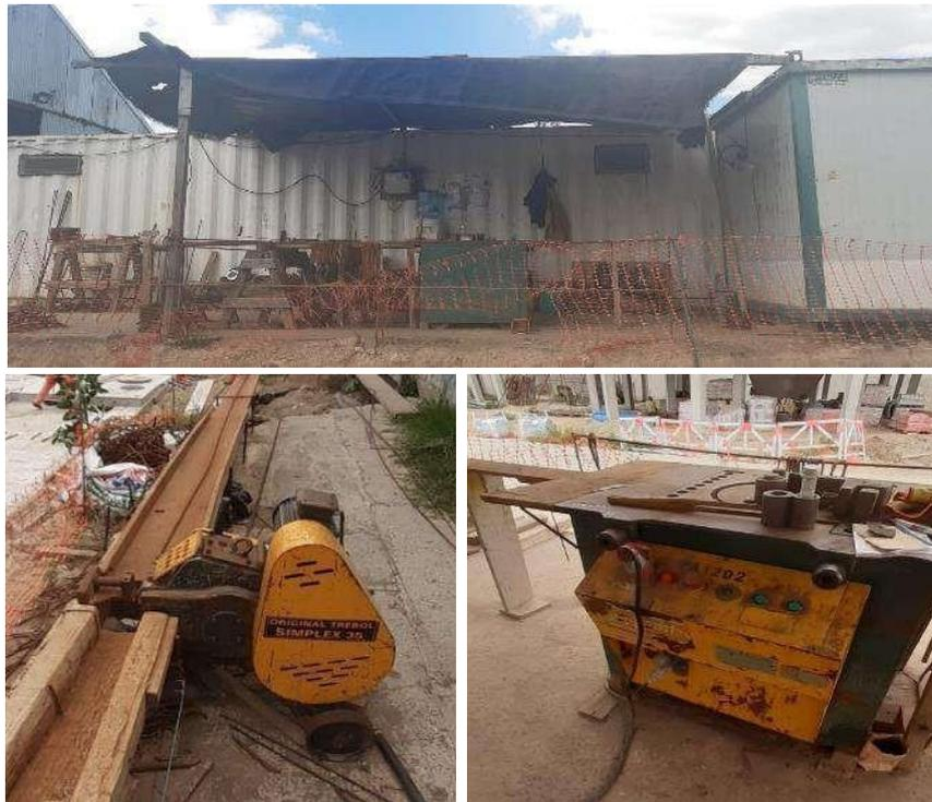
Imagen 1: Taller de obra, y máquinas de corte y doblado de barras.
