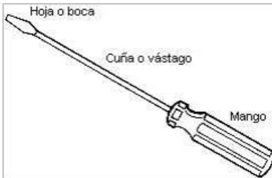
Partes de un destornillador
