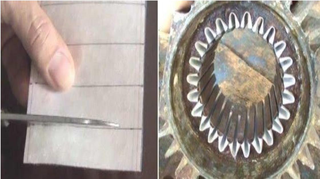
A la medida del largo debemos agregarle 2 cm para que los conductores no toquen el núcleo.
