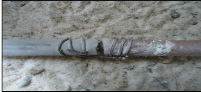
Figura 9. “Acople de manguera con alambre”
