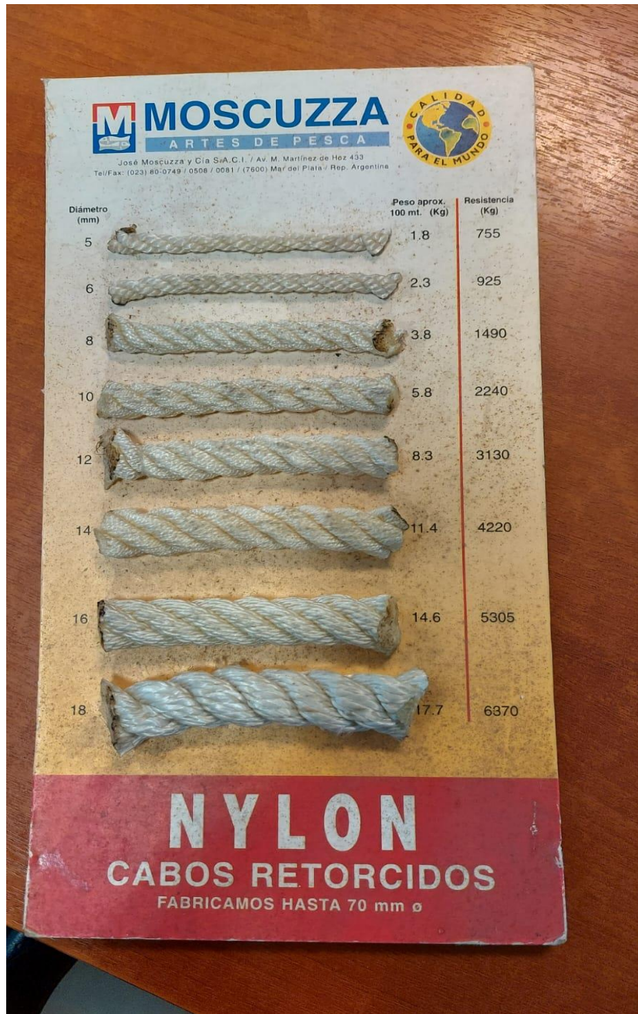
Imagen XXXI - Tabla de referencia para clientes de Cabos retorcidos de Nylon sobre la relación: Diámetro (mm), Peso aproximado (100 metros x kg), Resistencia (kg).
