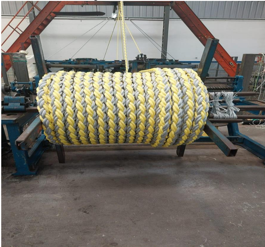
Imagen XXVII - Enrollado del cabo que va haciendo la trenzadora, ubicada en la parte de atrás del rollo.
