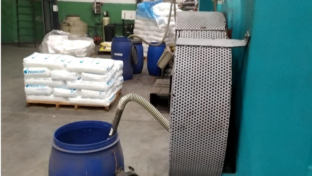
Imagen IX - Aspirador individual de MP a la tolva pequeña.
