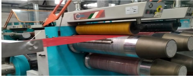
Imagen XII - Rodillos a velocidad constante.
