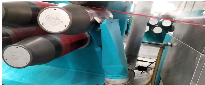
Imagen XIII - Rodillos a velocidad constante.
