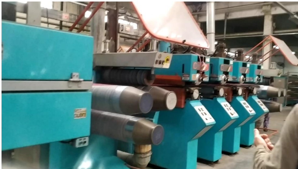
Imagen XVI - Rodillos a la salida del horno de estabilizado.
