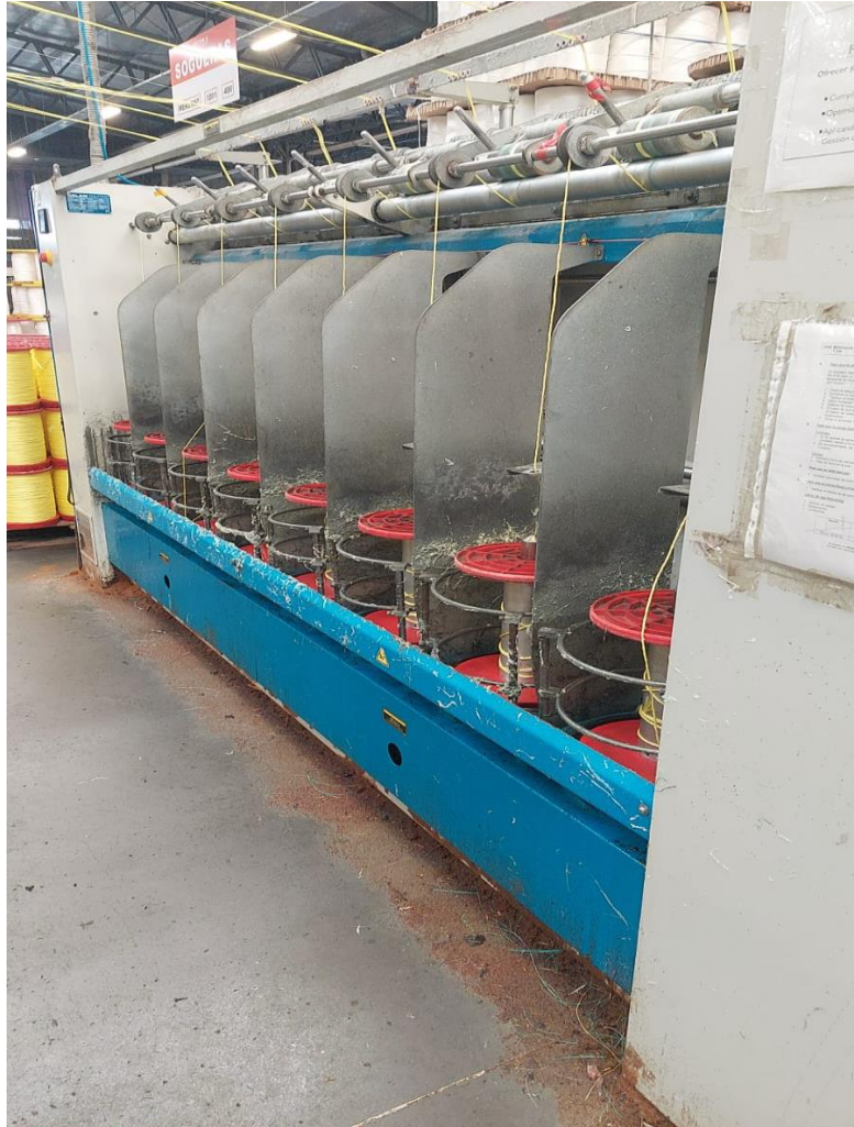
Imagen XXIII - Retorcedora. Las fibras se enrollan en sentido S o Z, cada uno a la vez.
