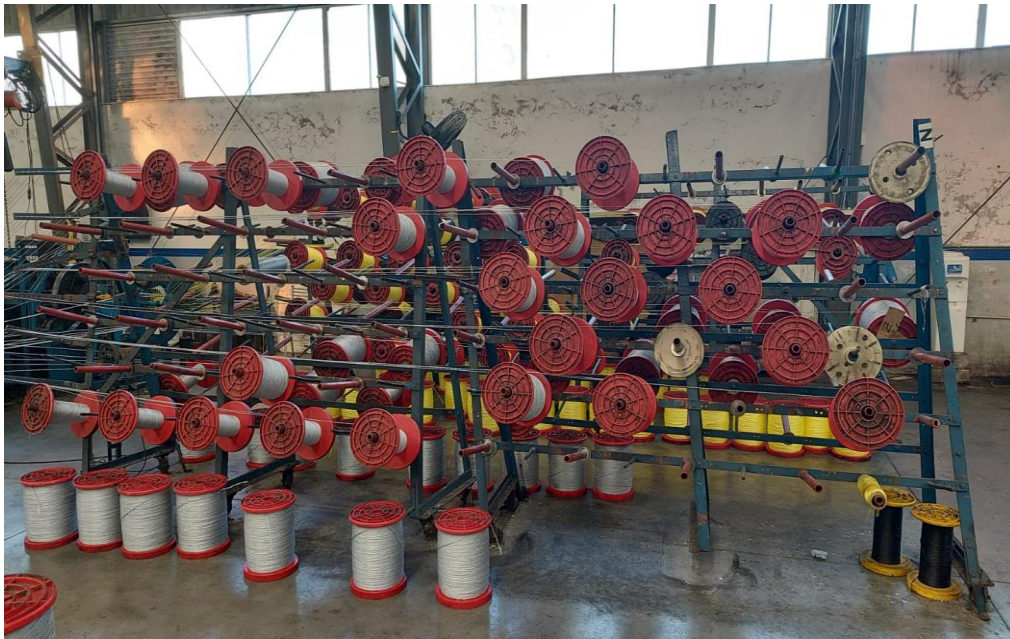
Imagen XXI - Rollos de fibras de 12.000 Denier provenientes de Planta II.
