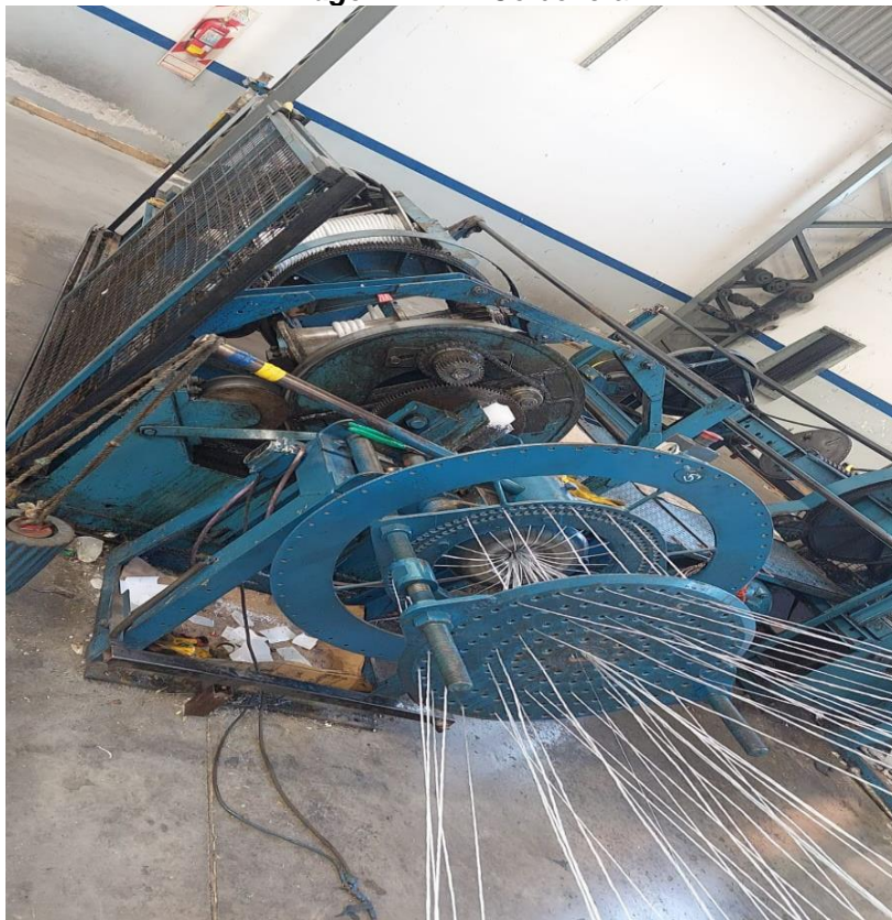
Imagen XXV - Alimentación de la cordonera. Como se puede apreciar, se colocan una determinada cantidad de fibras o filamentos para producir el cordón pedido.
