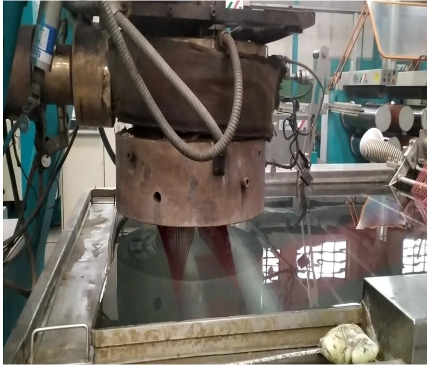
Imagen X - Salida del material extrudido. Como se puede observar, la plaqueta genera el filamento pedido.
