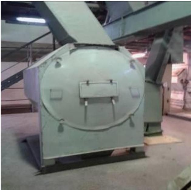
*Figura N°7 Criba cilíndrica*
