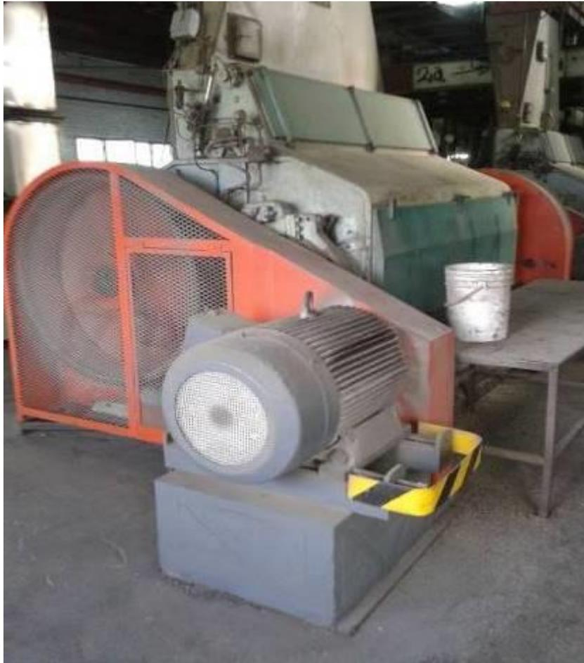
*Fig. N°18 Molino Laminador*
