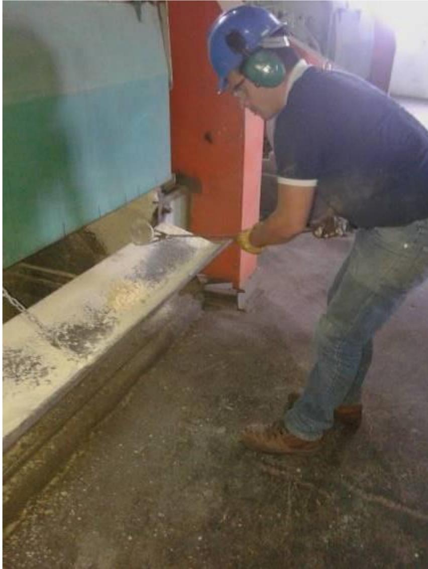
*Fig. N°19 Muestreo de Laminado*
