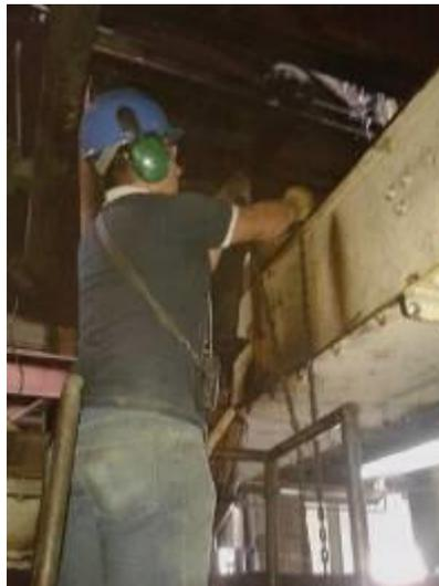
*Fig. N°24 Toma de Temperatura de Salida del Cocinador.*
