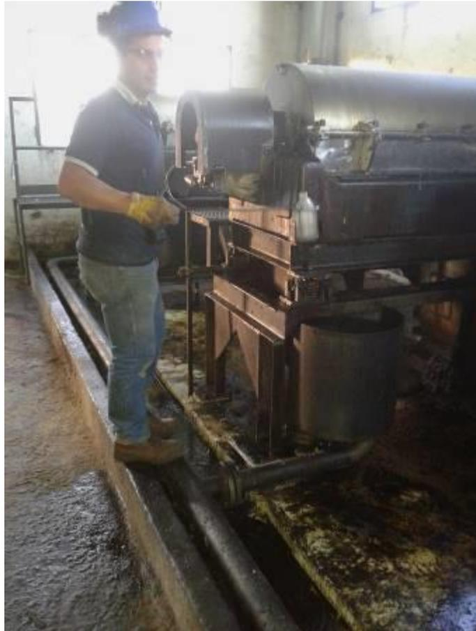
*Fig. N°26 Toma de Muestra de Aceite de Salida para Ensayo en Laboratorio.*
