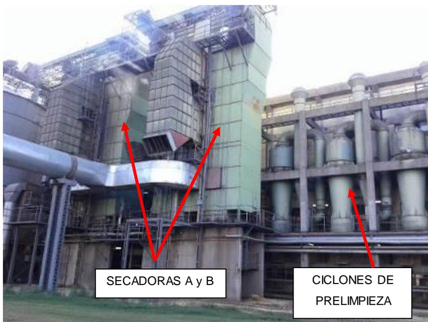
*Fig. N°11 Secadoras y ciclones de pre limpieza*
