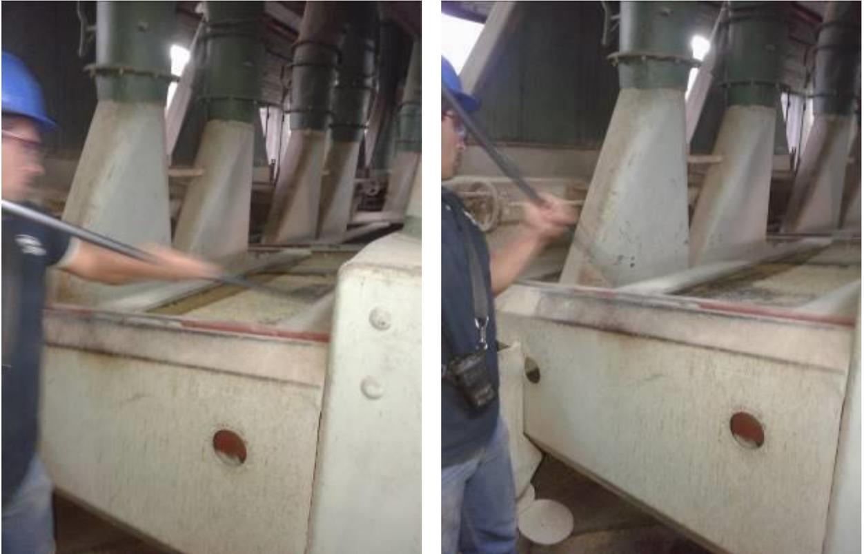
*Figura N°10 Op. N° 2 Cepillado de Tamiz Superior*
