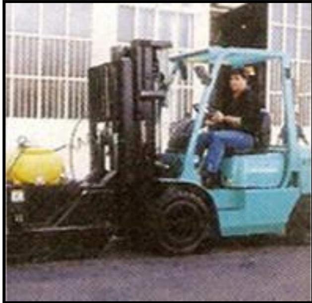
en una herramienta muy práctica que permitirá reducir la suciedad de los pisos. Su sistema de acople rápido permitirá en poco tiempo convertir un autoelevador en una barredora de gran rendimiento.
