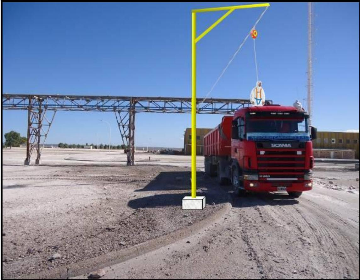
El cable de este sistema requiere ser chequeado en forma periódica, debido a su desgaste y ser remplazado cuando se observe su deterioro (aplica el mismo criterio de control que para los cables de izaje).
