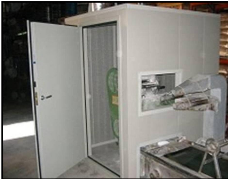
*Ejemplo de caseta fabricada con paneles acústicos aislantes.*
