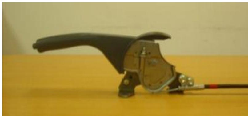
En esta área se ensamblan distintas piezas que forman el sistema de Freno de manos. Dichas piezas son: palanca de freno de mano, varilla de trinquete, perno, cable de freno, bastidor y funda.
