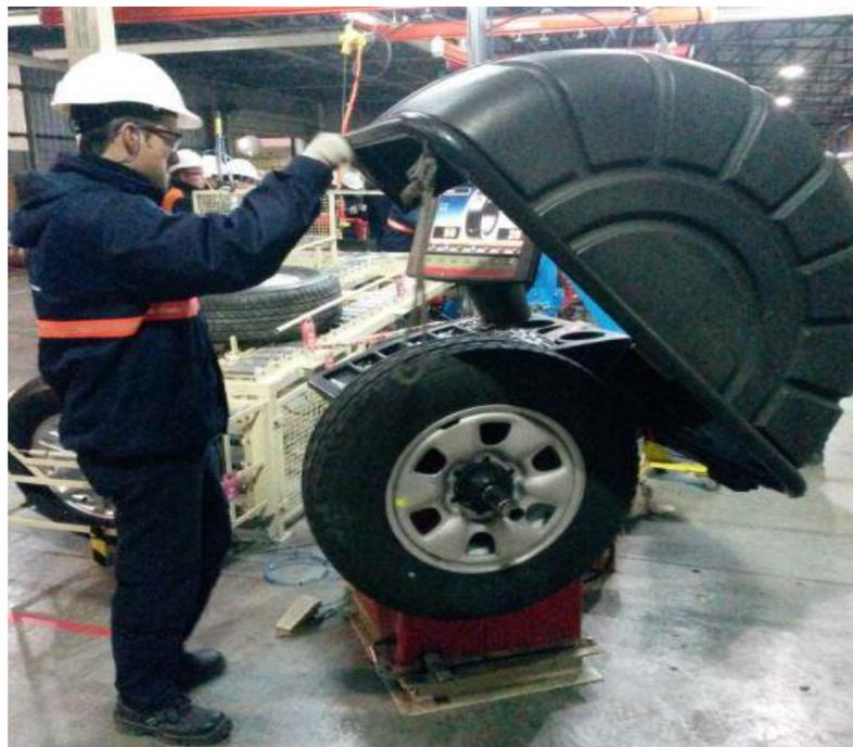
La fase del sub ensamblaje de llantas y cubiertas se efectúa en a través de un tambor giratorio que encastra la cubierta con la llanta. Una vez finalizada esta etapa el operario realiza el inflado de la rueda.
