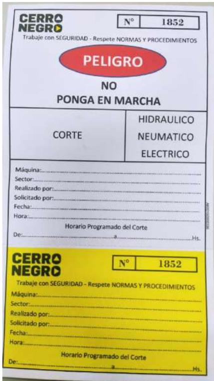
Tarjetas de bloqueo para aquellas tareas que tengan que efectuarse y, por ejemplo, haya presencia de energía eléctrica.
