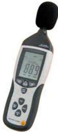
Con el objeto de determinar el nivel de presión sonora a la cual se encuentran expuestos los operarios en los distintos sectores de planta ladrillos, se realizaron las mediciones de ruido correspondiente a la altura del aparato auditivo de los operarios. En este caso se midió solo un porcentaje de la jornada de trabajo (tiempo de medición menor que el tiempo de exposición), ya que el resto de la jornada laboral tiene las mismas características de exposición al ruido.
