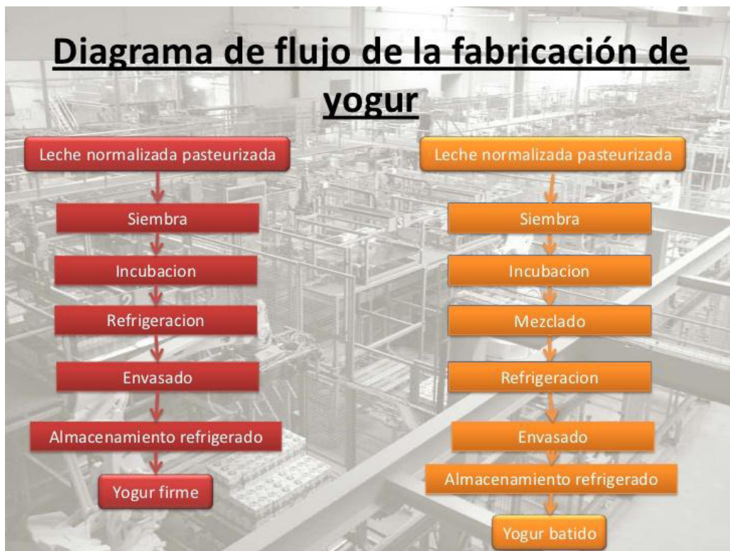
Imagen N°4: Elaboración de yogur firme y batido.
