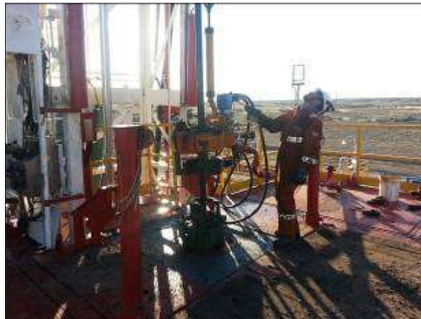
Foto 7.3.5 Peón boca de pozo acciona comando de llave hidráulica para desenroscar tubing y acopiar en peine de piso de enganche
