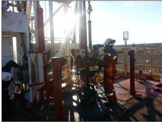
Foto 7.3.3 Peón boca de pozo saca tubing con llave hidráulica
