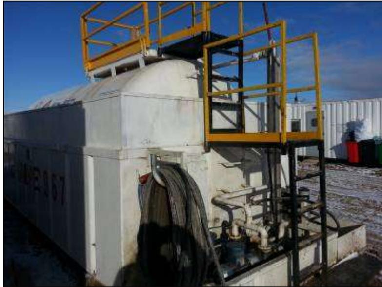
**Tanque de Gasoil de 23m3 con bandeia de contención**
