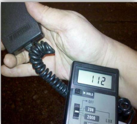
**Ilustración 17. Medición nivel de piso**
