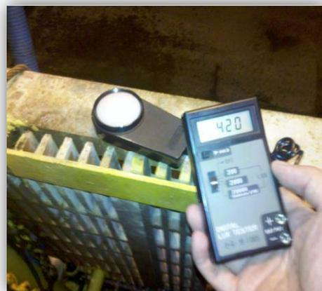
**Ilustración 18. Medición localizada nivel de plataforma de carga**
