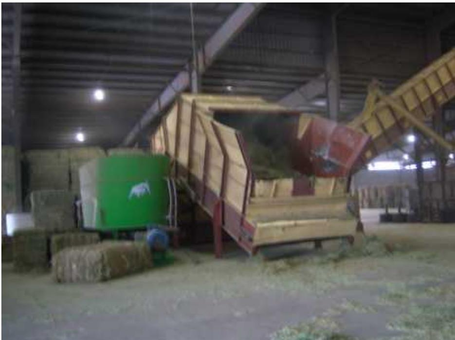
La alfalfa se desplaza desde la tolva de alimentación hasta la compactadora (prensa) por medio de una cinta transportadora de rodillos con una inclinación elevada de  $45^\circ$ , donde la alfalfa cae por gravedad hasta el lugar de prensado.
