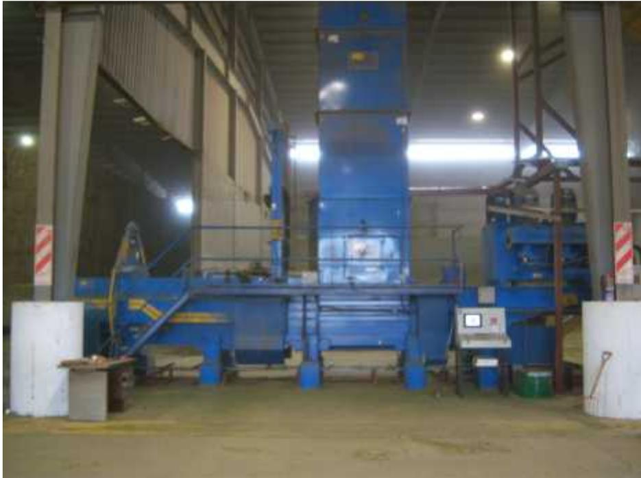
La misma está constituida por una tolva con dimensiones importantes, por donde se la alimenta mediante una pala cargadora con la alfalfa suelta.
