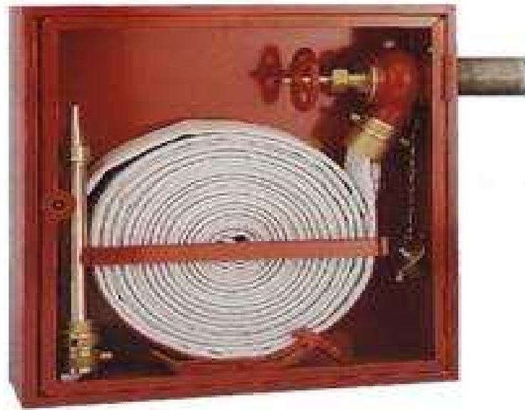
Las mangueras se encuentran dobladas de forma tal que en el caso de una emergencia, el brigadista la tome y al arrojarla al piso, la manguera se deslice de tal forma que permita dejar las dos puntas de la misma en la mano del brigadista, de esta forma se puede conectar la lanza a un extremo y el hidrante del otro extremo. Quedando el brigadista listo para atacar cualquier foco de incendio detectado.
