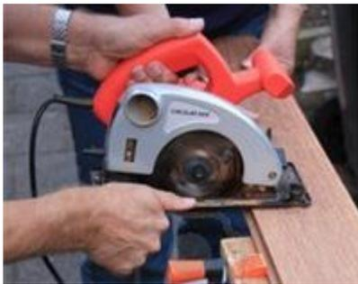
Con la sierra circular se realizan cortes de madera sobre un plano normal, con el fin de dimensionar, optimizar y definir el largo en tablas, esta se ejecuta a través de un disco de corte dentado, accionado por un sistema de correas que permiten efectuar el movimiento a través de un motor eléctrico.
