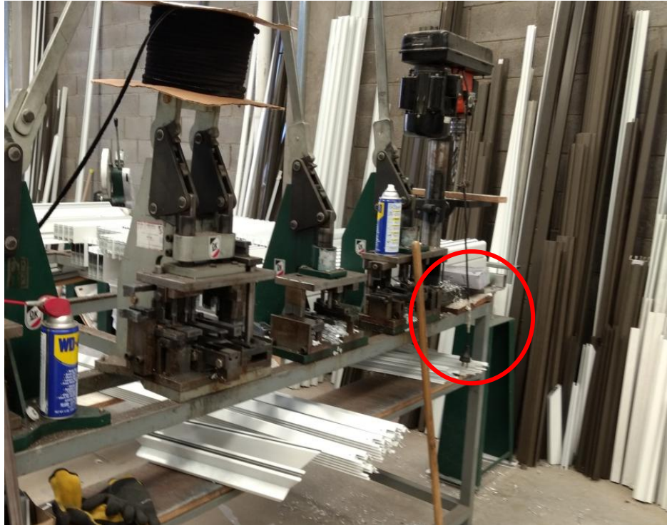
Foto N° 23 máquina de presar - cable de alimentación de corriente con cinta aislante
