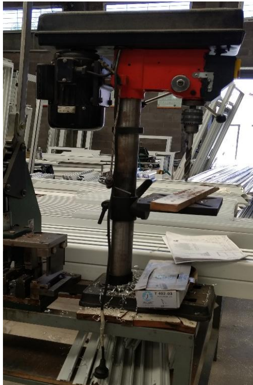
Foto N° 34. Taladro de Columna
