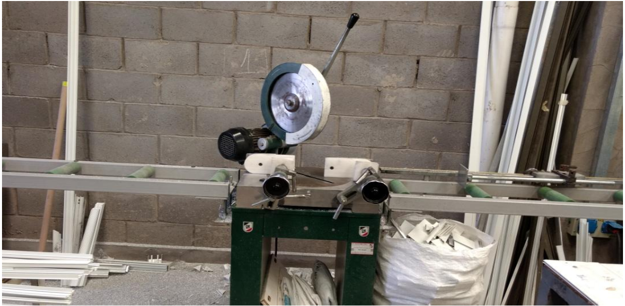
- Foto N° 2: foto de maquina sensitiva de corte
