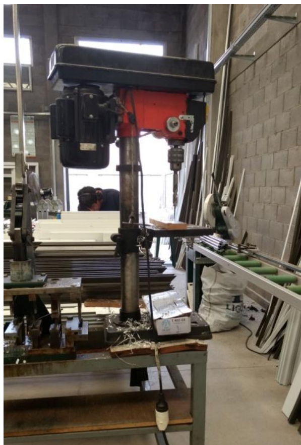
Foto N° 12 taladro de columna
