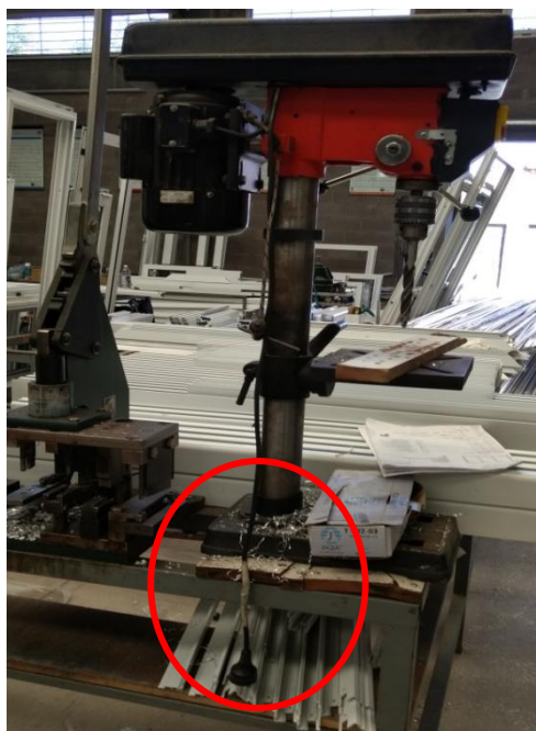
Foto N° 22 cable de alimentación con cinta aislante
