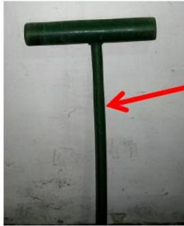
Toma la herramienta fabricada para empujar todo el material atrás de la cortina, dentro el molino.
