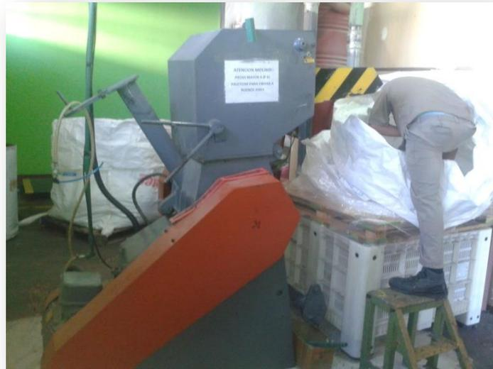
Una vez en el recipiente inferior las piezas trituradas son absorbidas por la aspiradora quien las deposita en un bags para su posterior traslado a stock de material recuperado.
