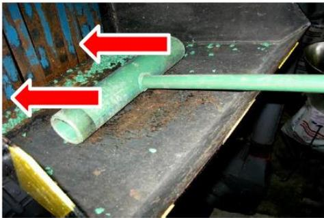
Se empuja lentamente el material pasando la cortina metálica dentro el molino.
