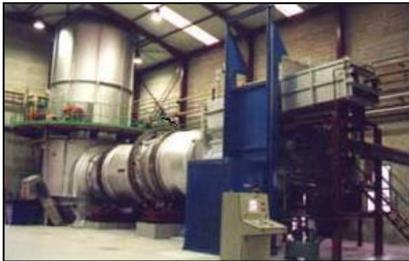
**FIGURA N°11.** Horno rotativo.
