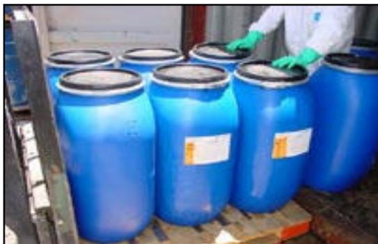
**FIGURA N°33.** Recipiente impermeable para el material derramado.
