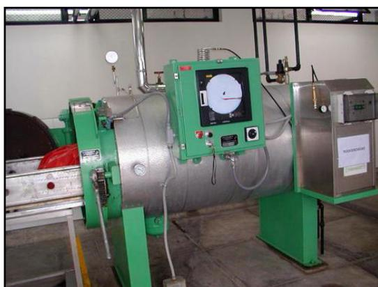
**FIGURA N°7.** Autoclave
