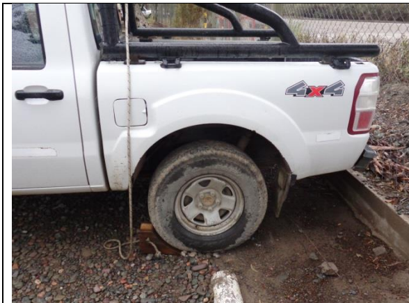
Foto N° 41 Taco de madera.
