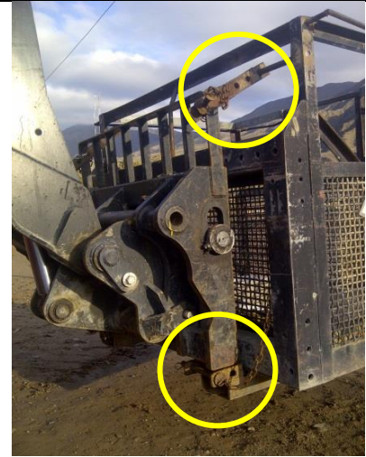
Foto N° 51 Sujeciones de la canasta al Manipulador Telescópico.
