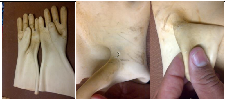
Foto N° 19 guantes di eléctricos dañados.
