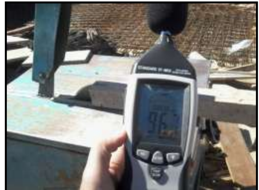
Imagen 4.2.5: Medición de ruido en sierra circular de banco
