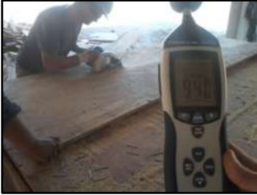
Imagen 4.2.2.: Medición de ruido en sierra circular de mano
