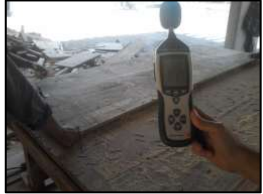
Imagen 4.2.3: Medición de ruido en sierra circular de mano
