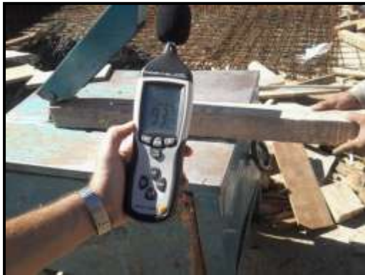
Imagen 4.2.4: Medición de ruido en sierra circular de banco
