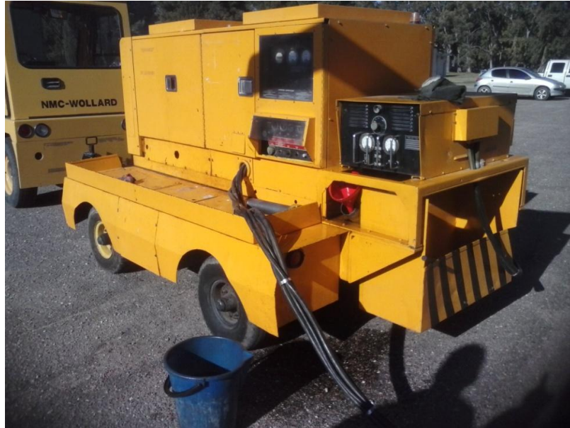
Foto N° 23- Carga de gas-oíl con un balde, se observa la mancha del mismo sobre el piso – Fuente Propia
