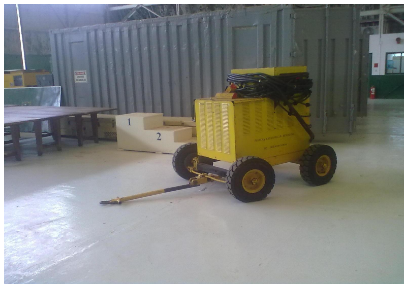
Foto N° 4 Grupo electrógeno 28 VCC - 115 VCA de 200 KVA (Fuente Propia)
