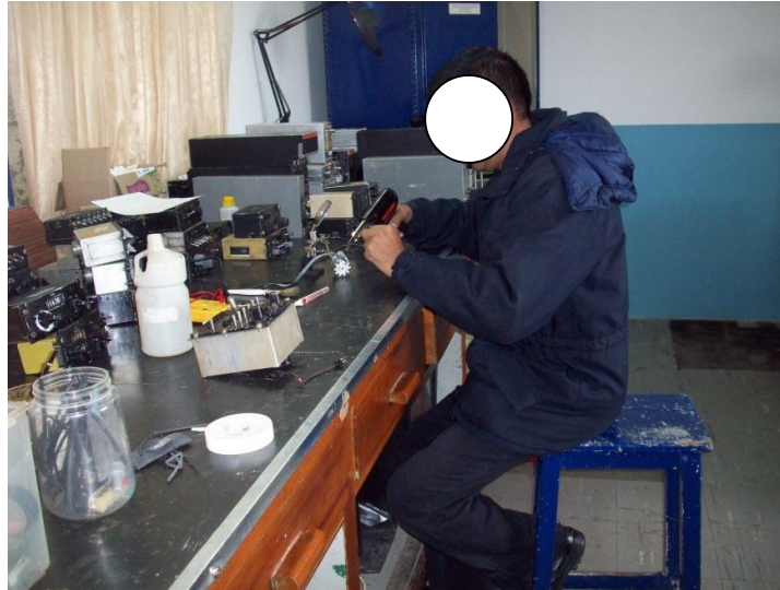
Foto N° 21 - Técnico realizando soldadura con estaño – Fuente propia.
