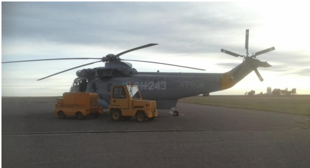
Foto N° 34 - Helicóptero en plataforma de vuelo con grupo electrógeno conectado-
