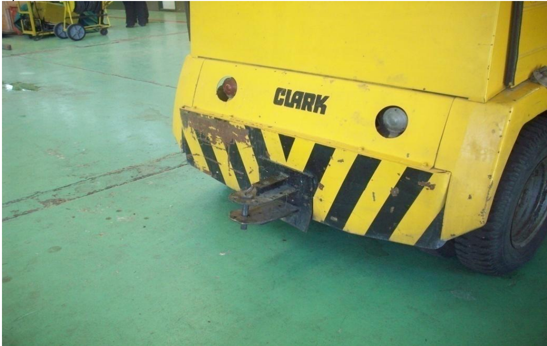
Foto N° 35 – Enganche y perno del Tractor Clark – Fuente propia.
