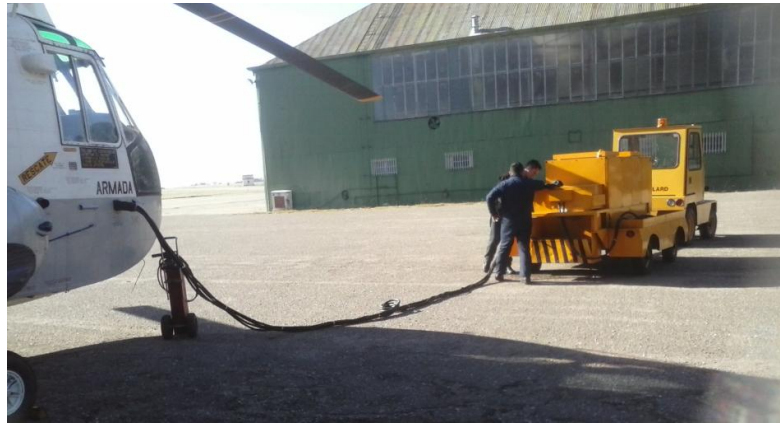
Foto N° 3 – Personal de la escuadrilla en el momento de dar alimentación eléctrica al aeronave Sea King para una inspección de rutina (Fuente propia)
