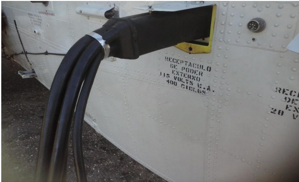
Foto N° 28 - Véase el conector de energía del manguerote y el difícil agarre que éste supone, sumando la altura de la toma del aeronave (1,6 metros).- Fuente propia
