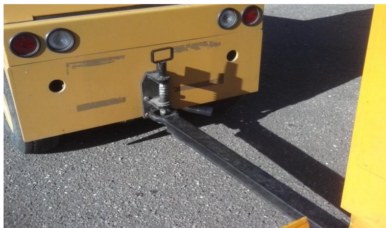
Foto N° 37 – Nuevo enganche con perno y agarre, fabricado según sugerencia. Fuente propia
