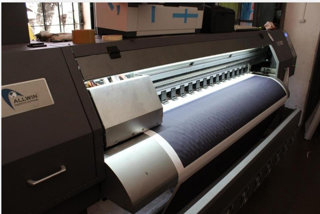
Impresora de inyección de tinta de 180 cm de ancho, imprime imágenes fotográficas de alta tecnología. Tiene cuatro cabezales que permiten inyectar gotas de tintas de diferentes tamaños, también cuenta con tecnología de punta, que puede llegar a imprimir 100mts<sup>2</sup> por hora. Contiene soporte de material de impresión, que son rollos angostos y anchos, y cuenta con un sistema de recolección del material incluido, que proporciona estabilidad y comodidad al operador durante la impresión.
