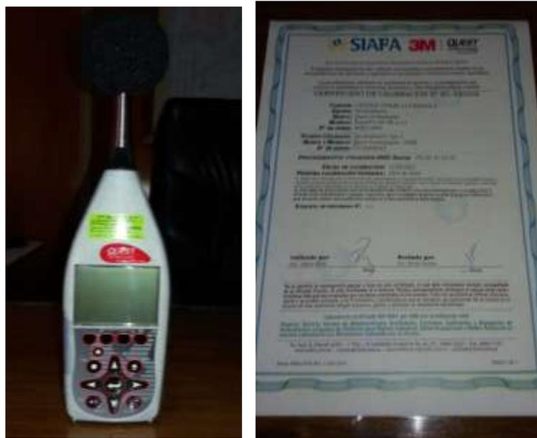
Figura N°16: Decibelímetro y certificado de calibración
