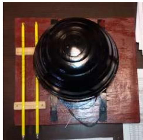
**Figura N° 26 Equipo “casero” de medición de carga térmica**
