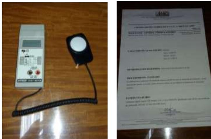
Figura N°25: Luxómetro y Certificado de calibración
