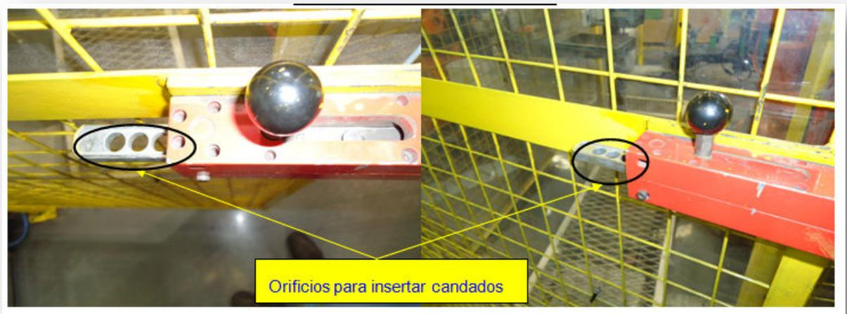
Fig. N° 33. Sistema adaptado para bloqueo con candado
