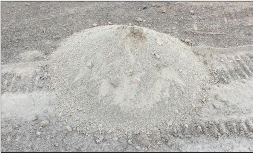
*Imagen 1:* Material expulsado por ciclón de perforadora. Se debe recolectar una muestra.
