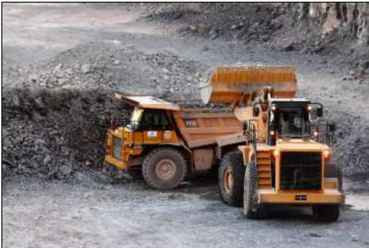
La pala cargadora Caterpillar 990H carga a los equipos Caterpillar 773D con piedra caliza molida producto de las voladuras.
