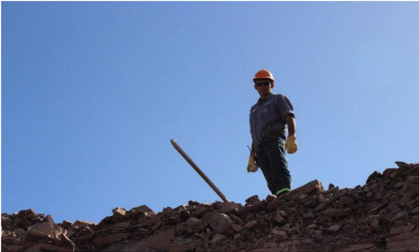
*Imagen 1:* Operario perforista utilizando vara para la medición y marcado de grillas de perforación (vista inferior).
