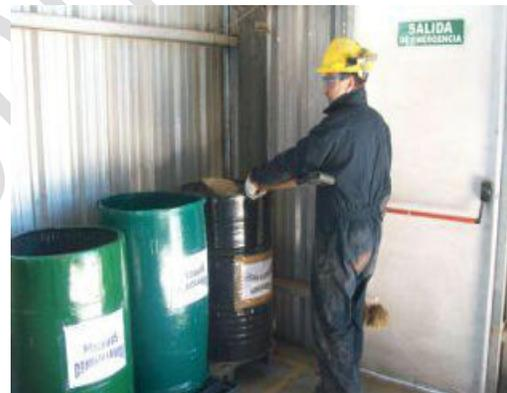
5) El material absorbente usado se recoge con pala y se coloca en una carretilla. Sobre la mancha se vuelve a agregar absorbente.
