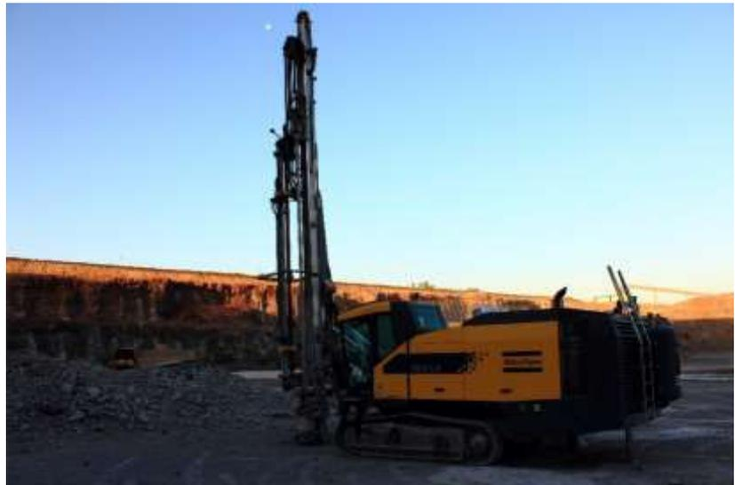
*Imagen 1 - Perforadora Atlas Copco Roc L8 a la sombra de un frente de cantera*
