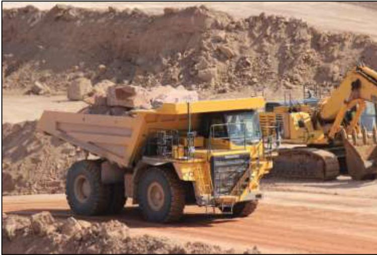
Cuando no se realizan tareas de trituración por estar llenos los depósitos en la planta de cemento, se agregan a la tarea de destape a los llamados “volquetes”, camiones capaces de llevar una carga de hasta 50 toneladas.
