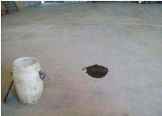
1) Derrame de hidrocarburo en el piso del Taller. A la izquierda se observa recipiente con material absorbente
