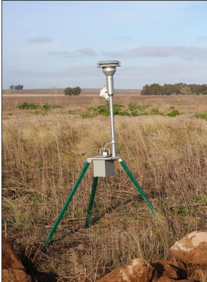
*Imagen 1:* Bomba de captación de particulado en suspensión.
