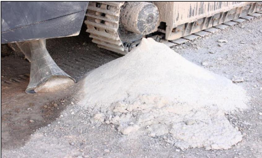
*Imagen 2:* Material expulsado sistema de aspiración. Se debe tomar una muestra.
