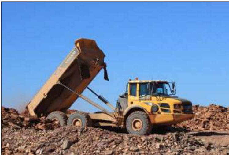
Se aprecia a un equipo Volvo A30F durante la descarga de material arcilloso. Es muy importante que el botadero cuente con berma de seguridad. Está prohibido la descarga de material sin berma.
