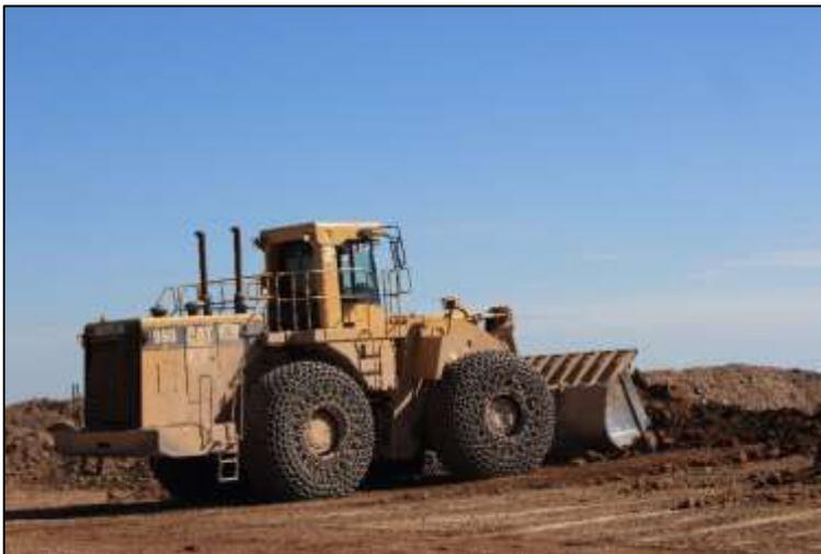
Conforme los camiones van realizando las distintas descargas, una pala de carga frontal empuja el material por el risco del botadero y construye las bermas de seguridad. De este modo el botadero gana altura y superficie.
