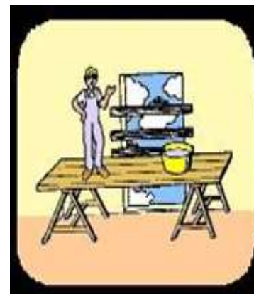
Andamio situado junto a una abertura protegida
