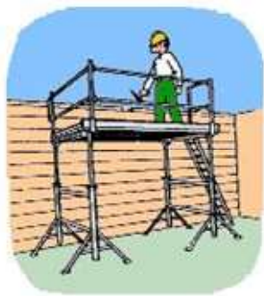
Protección del contorno, con barandas y zócalos
