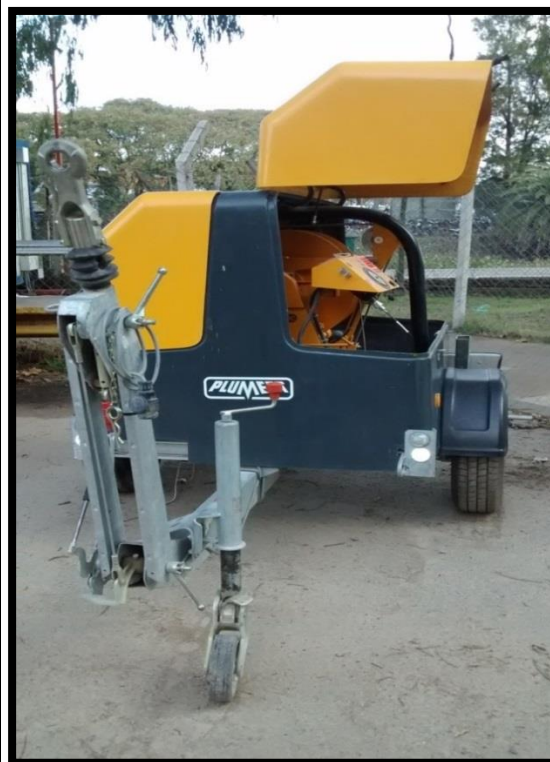
- Malacate a explosión, usado para tendido de cables de potencia.
