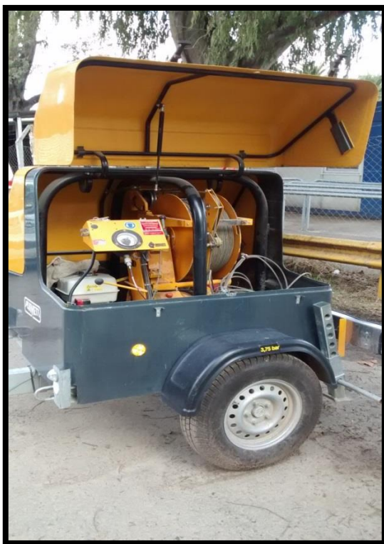
- Malacate a explosión, usado para tendido de cables de potencia.
