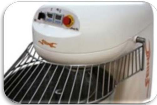
Fig.15 Amasadora con protección y dispositivo de parada de emergencia.
