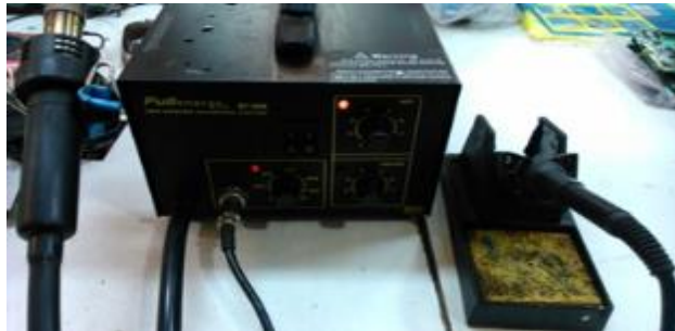
Figura 1.4.5 Estación de soldado
