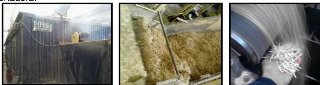
**PULIDO y SELECCIÓN.** Del secadero, los palitos son transportados neumáticamente a un tambor pulidor, en el cual, y tras un proceso de clasificación, son enviados a los silos desde los que, por sistema neumático, se alimenta a las máquinas continuas de fabricación.
