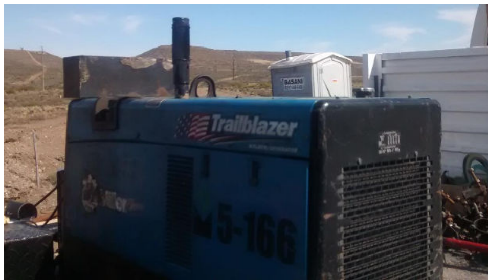
Imagen 17 – Dispositivo arresta llamas en escape de motosoldadora.
