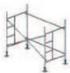
Colocación de Largueros y Diagonales (1º cuerpo).
