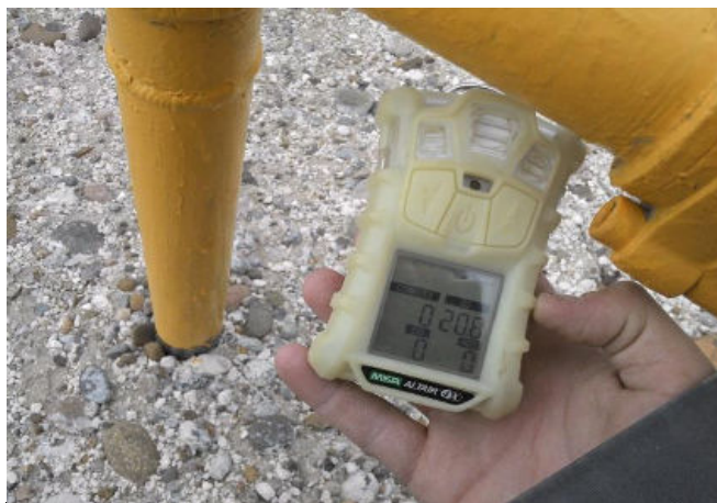
Imagen 9 – Medición de gases para trabajos próximos a manifold gasoducto en proceso.
