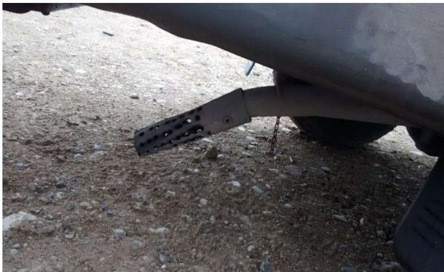
Imagen 16 – Dispositivo arresta llamas en escape de vehículo liviano.
