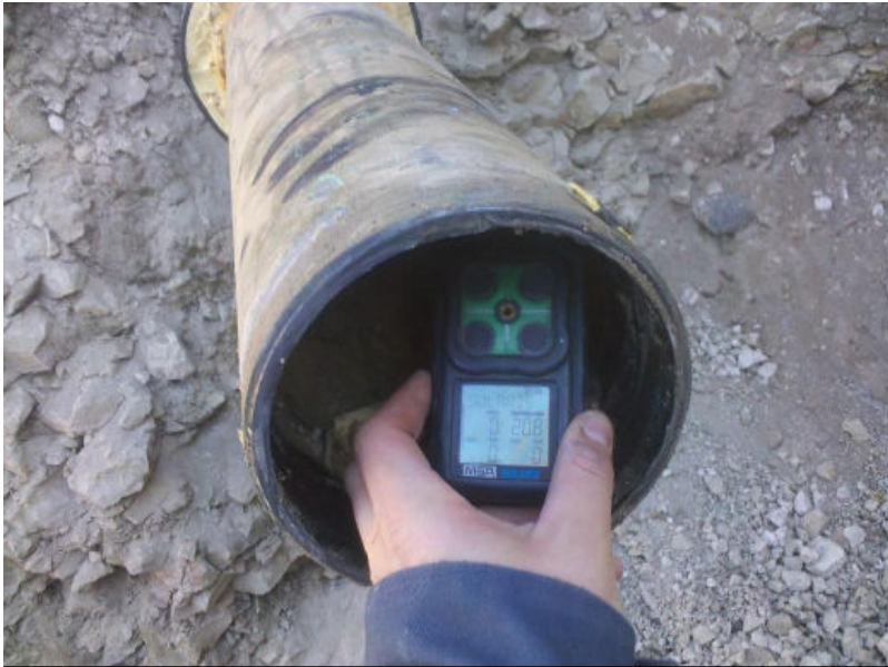
Imagen 10 – Medición de gases en oleoducto ya habiéndose realizado una separación de atmosferas por medio de tapón de bentonita.
