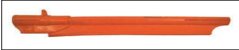
Son utilizadas para cubrir conductores y construidas en un elastómero termoplástico (Salcor). Están aprobadas para usar en líneas de hasta 36 Kv. El Salcor es una goma sintética que no es dañada por el ozono que se genera en el efecto corona y fácilmente se puede dejar colocado sobre líneas vivas durante una semana corrida sin peligro. El color de este material normalmente es anaranjado.
