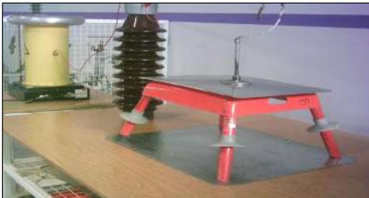
Le brinda al hombre un nivel de aislamiento respecto de tierra. Es de fibra de vidrio y resina epoxi, de gran resistencia mecánica y amplio poder dieléctrico. Esta plataforma es imprescindible como ya se indicó en trabajos sobre instalaciones de M.T. con tensiones mayores a los 1000 V. donde no se puede ubicar el hidroelevador aislado.
