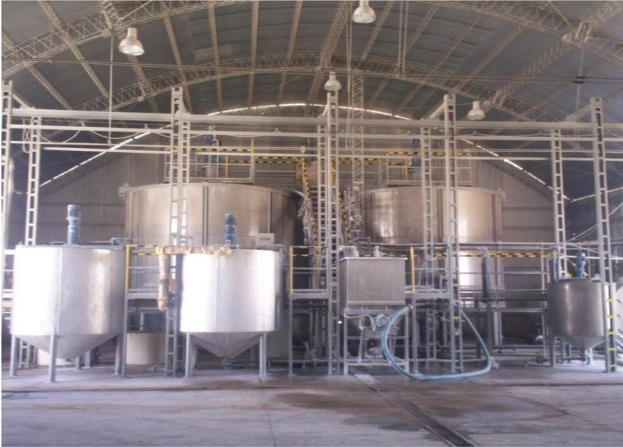
**Precipitación:** a la salmuera tratada se le agrega Carbonato de Sodio para producir la precipitación del Carbonato de Litio, el cual se filtra y posteriormente se seca, previamente acondicionada.
