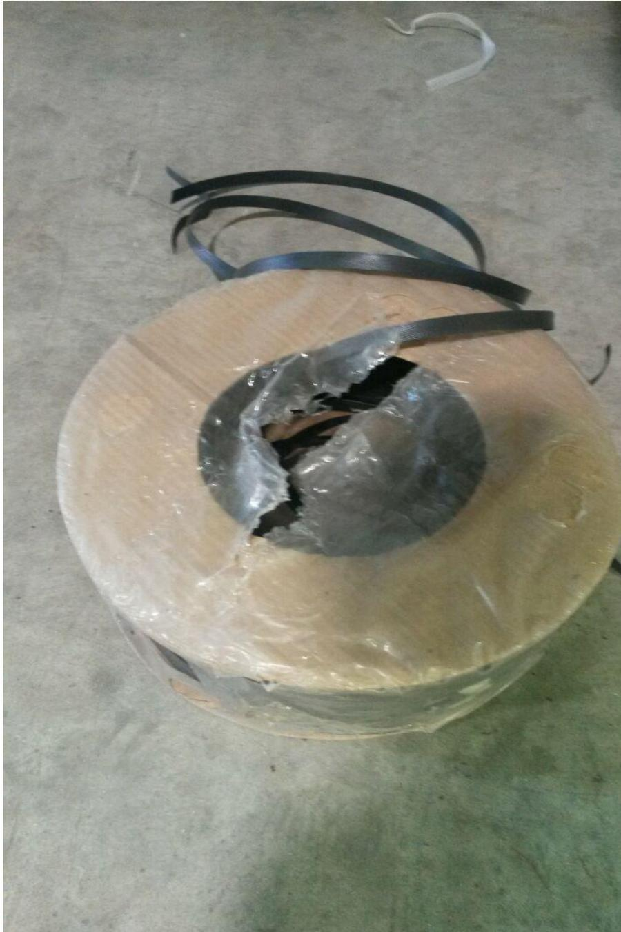
**Rollos de flejes de plástico:** son utilizados por el estibador para flejar (apretar y sujetar las cajas estibadas. Este fleje se coloca en forma manual con una máquina muy sencilla o con una máquina flejadora. Se deben manipular con guantes para evitar posibles cortes en los dedos de las manos. No hay registros de accidentes al manipular flejes.
