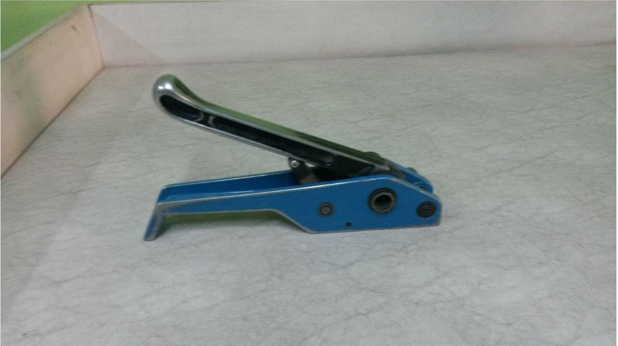
**Flejadora manual:** Se utiliza para flejar a mano los pallets de cajas de fruta estibadas. Una vez estibadas, se colocan los esquineros de cartón y luego se flejan con los flejes de plástico para asegurar que la estiba no se mueva y se caiga al ser manipulada. Esta herramienta no implica un riesgo para el estibador.
