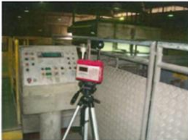
Medición de Niveles de Carga Térmica
