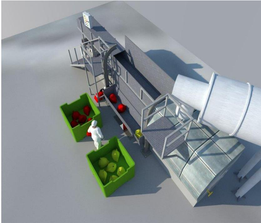
El sistema hidráulico está compuesto por una caja metálica con medidas de igual dimensión que el superior construido con chapa lisa de un espesor de 4 mm, un Cilindro telescópico, la Bomba hidráulica de 32 litros, Perfil normal U 200, PNU 20, Perfil normal u 160, PNU 16, una Rejilla
