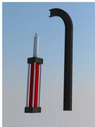
Vista de corte del funcionamiento de cajón que transporta los residuos, cabe destacar que su interior es de chapa lisa, para mejor desplazamiento de los residuos al ingresar al cajón primario que lleva al ingreso del horno.-
