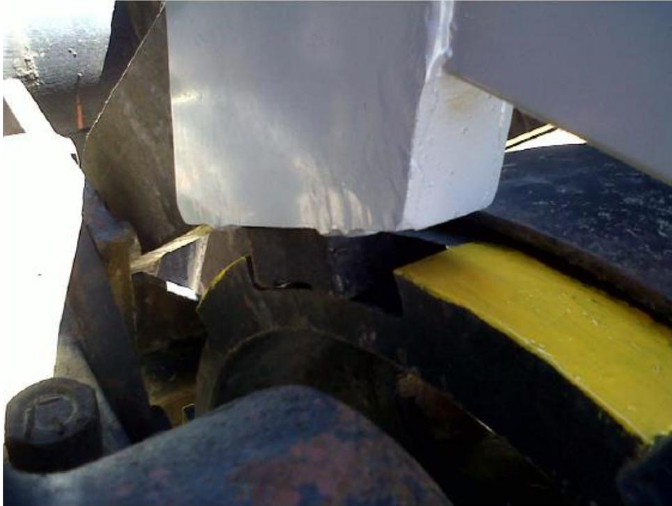
Traba mecánica dentro del canal de la rueda dentada
