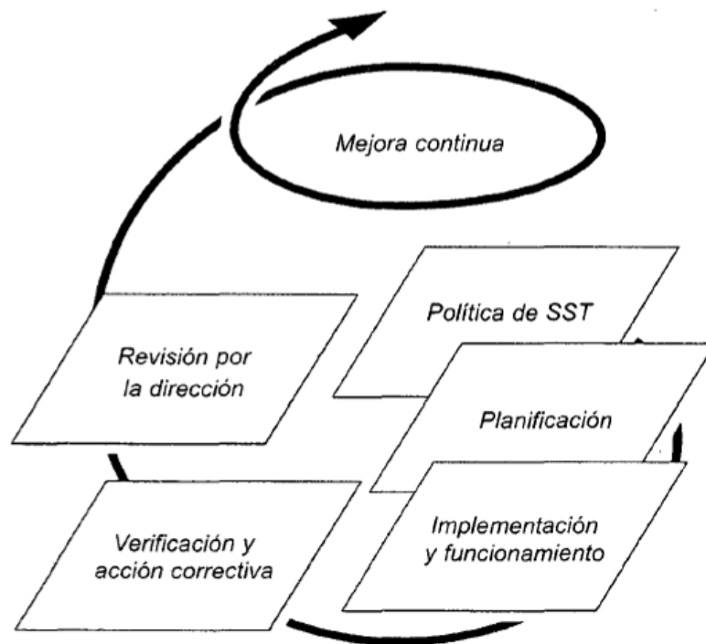
Modelo de sistema de gestión de la SST para este estándar OHSAS
