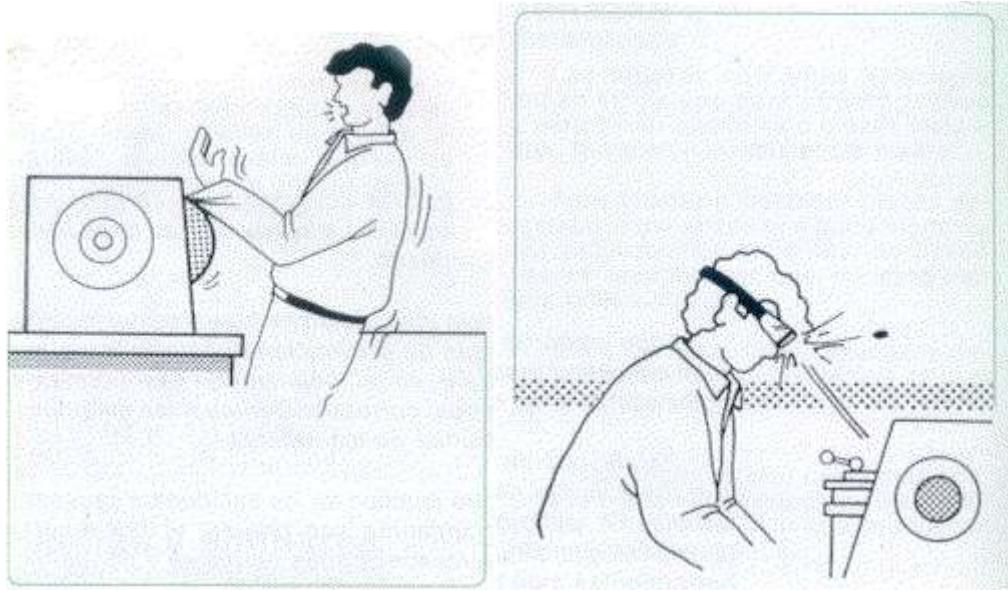
Figura 77: Posibles accidentes de atropamiento y proyección de partículas.
