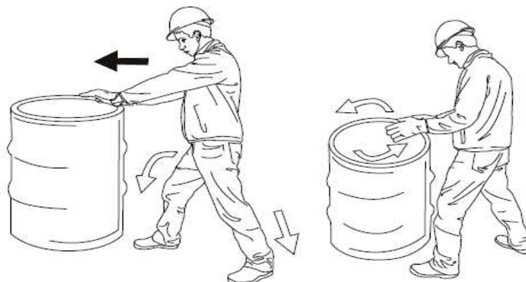
Figura 67: Explicación del movimiento correcto de barriles.
