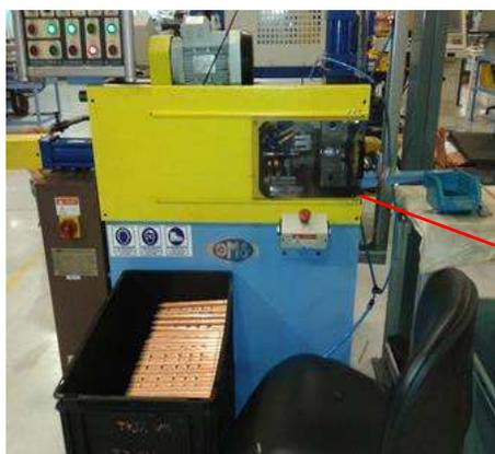
Después del accidente de Brua Dario se instalaron en la maquina estos sensores de corte. Cortaban el funcionamiento de la maquina una vez que se corría el acrílico.
