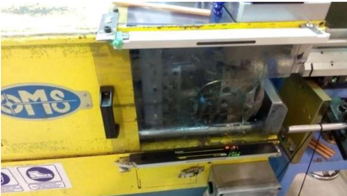
Fotos: Sensores infrarrojos y barreras colocados en máquinas END FORMING
