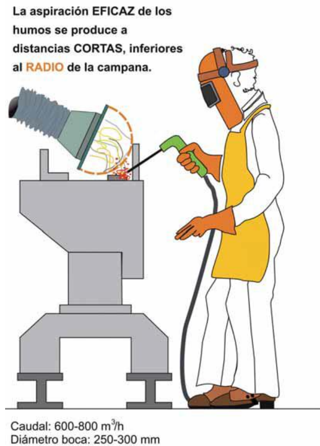
Figura 47 – Soldadura con Campanas simples de Captura
