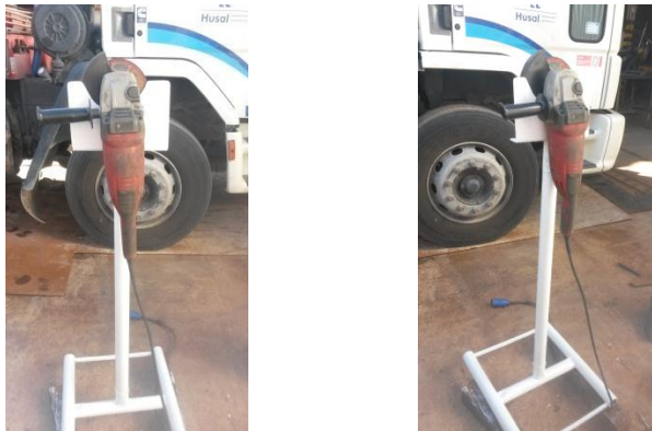
Figura 4 – Diseño de Soporte para Amoladoras
