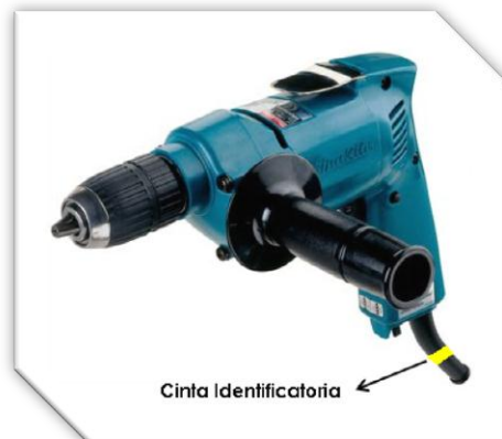
Figura 56 – Taladro con Cinta Identificadora
