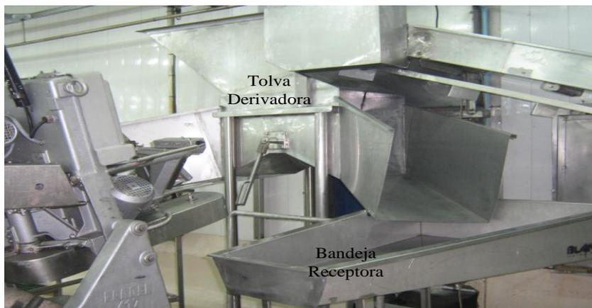
Imagen N°40. Tolva Derivadora y Bandeja receptora
