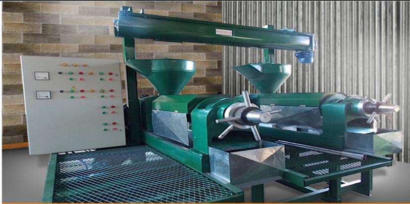
El primer circuito, mediante el prensado se obtiene el expeller el cual se transporta por batea abierta para favorecer al enfriado y se adiciona un poco de agua para recuperar la humedad perdida en el proceso (este agregado es opcional). Luego el expeller sale al depósito donde está listo para ser succionado por el tubo sinfín que con la ayuda de la pala mecánica será cargado en el camión para su traslado.
