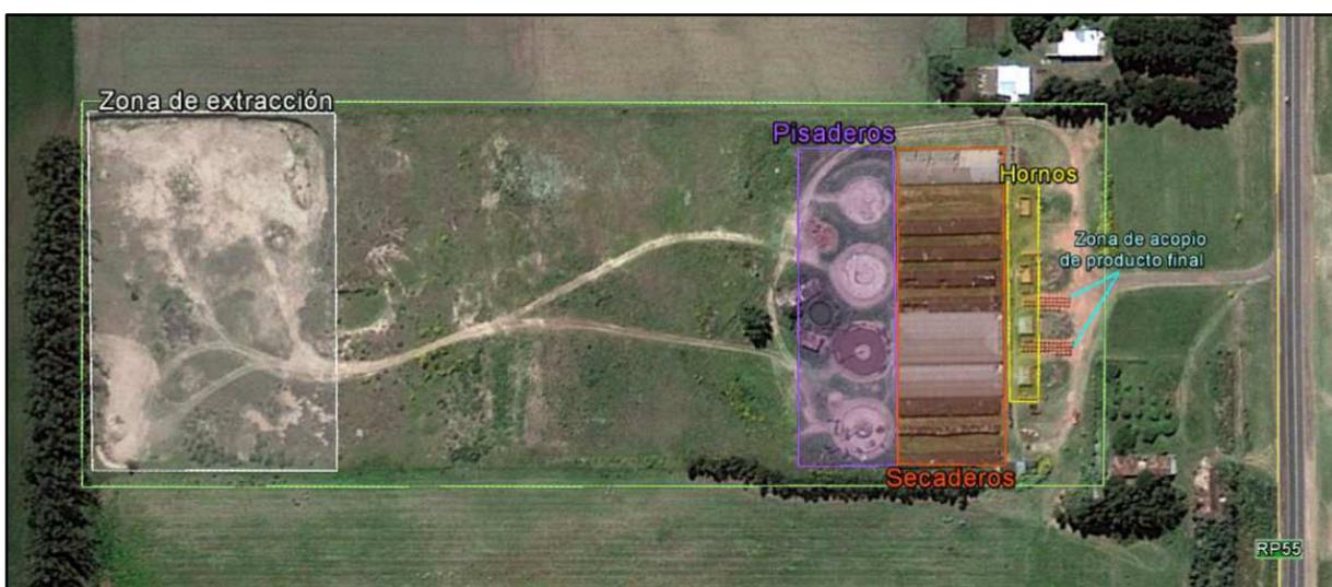
Figura 5.1. Distribución en planta de ladrillera típica de la ciudad de Balcarce.
