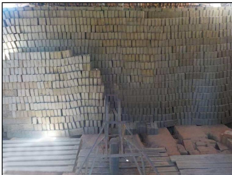
Figura 5.8. Disposición de los ladrillos en el horno.
