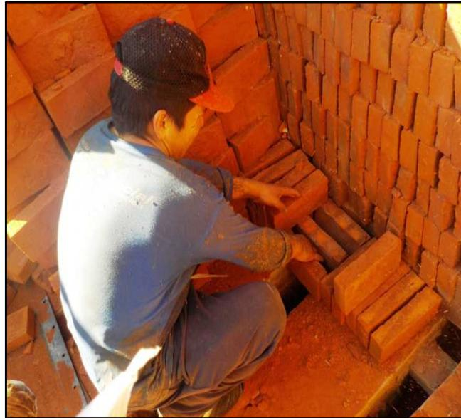
Figura 5.11. Proceso de descarga de los ladrillos.
