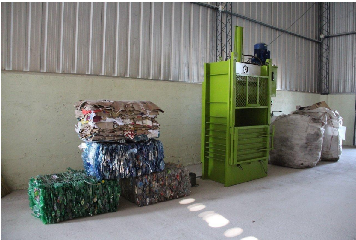
Imagen 7: materiales reciclables compactados luego de su clasificación en la Planta de separación de RSU. Fuente: Municipalidad de Lobería.
