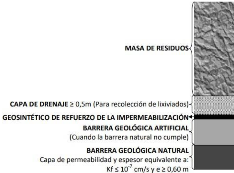
Ilustración 22: Esquema general de impermeabilización de Rellenos Sanitarios
